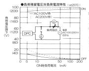
ON このような負荷の場合は DPCの出力ON時の電流 が5mA以上流れるよう 、負荷と前列に抵抗を接 続してください。 また、出力ON時の電流 は、できれば10mA以上 流されることを推奨しま す。最大雷流は200mA です。
