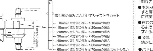
5) 付属の⑫裏面ハンドル固定フレートおよび⑬裏面ハンドル固定丸座にて⑪裏面ハンドル用シャフトのシャフト位置決めピンを挿み込み、⑮ねじE2本にて固定してください。(図10)
