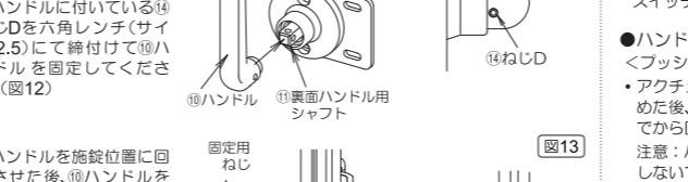
7) ⑯ハンドルに付いている⑭ねじDを六角レンチ(サイズ:2.5)にて締付けて⑯ハンドルを固定してください。(図12)
