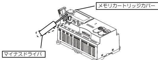
メモリカートリッジカバーを取り外した後、メモリカートリッジの△マークと、SmartAXISの△マークが合うように、方向に注意してメモリカートリッジを取り付けてください。
