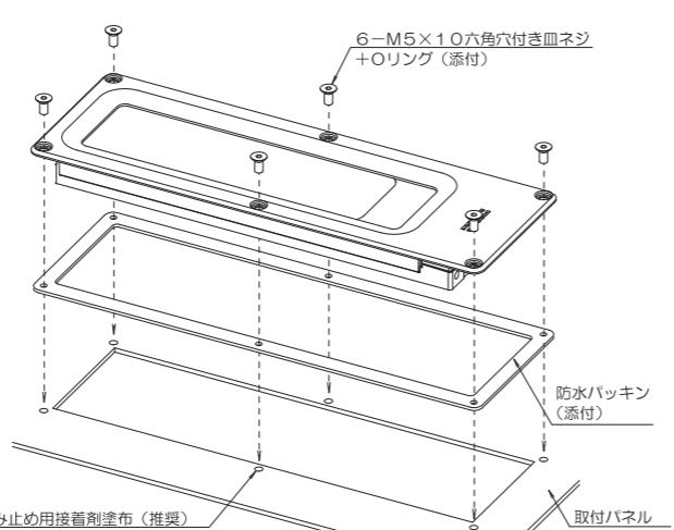
① パネルのめねじ側にねじのゆるみ止め用接着剤を取付面側にはみ出さないように塗布してください。
