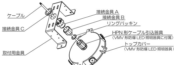
2. HPN形ケーブル引込器具と接続金具Bを強固に締め付けてください。
