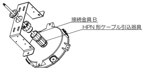
3. 接続金具Bに接続金具Aを押し込んでください。押し込む際にOリングが接続金具A側のOリング取付溝からはみ出さないようご注意ください。
