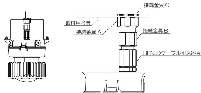
6. パイプを取り付けて、接続金具Aの止めねじ2箇所を締め付けてください。
