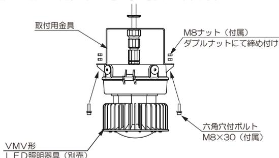
5. 接続金具Aを固定しながら接続金具Aと取付用金具に隙間が生じないように、取付金具Cをしっかりと締め付けてください。
