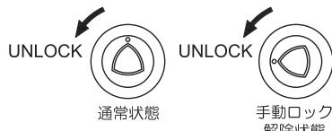
通常状態／手動ロック解除状態の切替操作は、付属の赤い樹脂Keyにて右図のように90度完全に回してください。途中で止めたまま使用しますと、誤動作や故障の原因となります。(手動ロック解除状態では、扉を閉じてもロックがかからず、メイン回路も開いたままです。)また、この手動ロック解除Keyを安全スイッチ本体に取付けた状態でご使用になりますと、常時機械稼働中にロック解除する危険な機会を与えることとなり、安全規格に適合しません。本製品にて取付けた状態で保持できない構造としていますが、お客様におかれましてはKeyのお取り扱いにはご注意ください。
