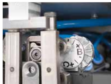
トリガーセンサを調整することで、適切なストリップ長を調整可能。
