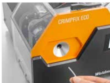
圧着長さ8mmなので高速圧着が可能。
