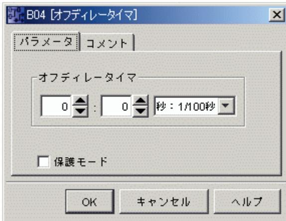
[ブロックプロパティ]ダイアログボックスは、数個のタブで構成されています。各ブロックには[コメント]タブがあり、適切なブロックコメントを入力できます。ブロックによっては[パラメータ]タブがあり、特定ブロックパラメータを指定できます。入力シミュレーションパラメータは[シミュレーション]タブで設定します。
