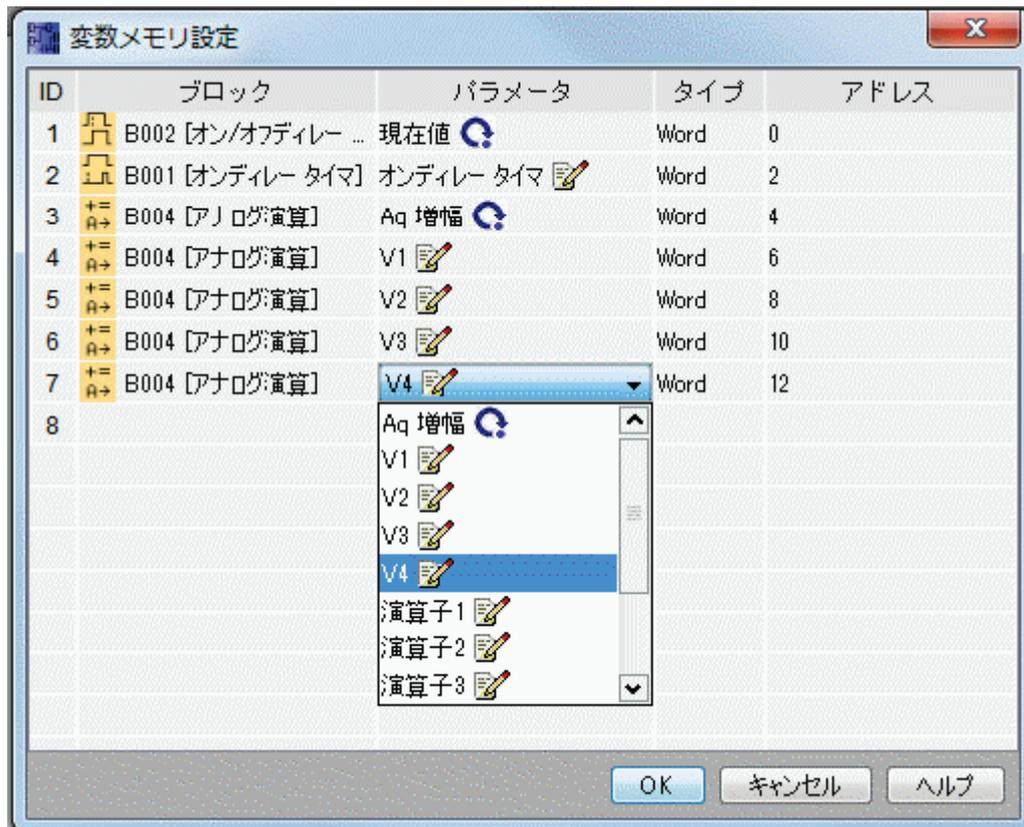
[ブロック]列には、現在のプログラムにおける SFB のパラメータが一覧表示されます。[パラメータ]列には、対応するブロックのパラメータの選択リストが表示されます。[型]列には、選択したパラメータのデータ型が表示されます。[アドレス]列も設定可能です。この列を使用して、パラメータ値の保存に使用する VM アドレスを特定します。
