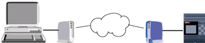
[ツール->モデムの接続]メニューコマンドを選択して、WindLGC を搭載した PC とスマートリレーベースモジュールの間で使用するモデムを設定するプロセスを開始します。リモート側のスマートリレーベースモジュールは、モデムにも接続されているためいつでもネットワ
