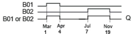
2つの年間タイムスイッチ SFB を、使用しているプログラミングインターフェイスに配置します。第1の年間タイムスイッチのオン時間を 03.01 に、オフ時間を 04.04 に設定します。第2の年間タイムスイッチのオン時間を 07.07 に、オフ時間を 11.19 に設定します。
