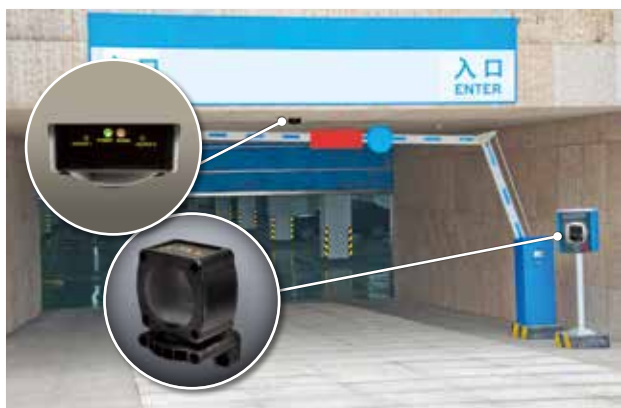
入場ゲートでの車両検知 (センサ本体は樹脂筐体箱の中の設置)
