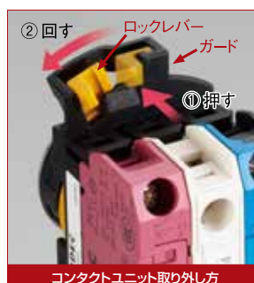
コンタクトユニット取り外し方
