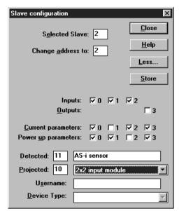
このダイアログボックスでは、AS-i スレーブアドレスの変更、AS-i パラメータや AS-i コンフィギュレーションデータの設定を行います。また、 入力と出力のテストも行うことができます。
