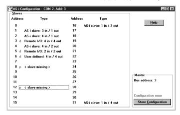
6. AS-i スレーブを 1 つ選択してクリックします。スレーブコンフィギュ レーションのダイアログボックスが表示されます。
