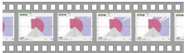
防護領域に人がいない状態 防護領域に人が接近 防護領域内に人が侵入
