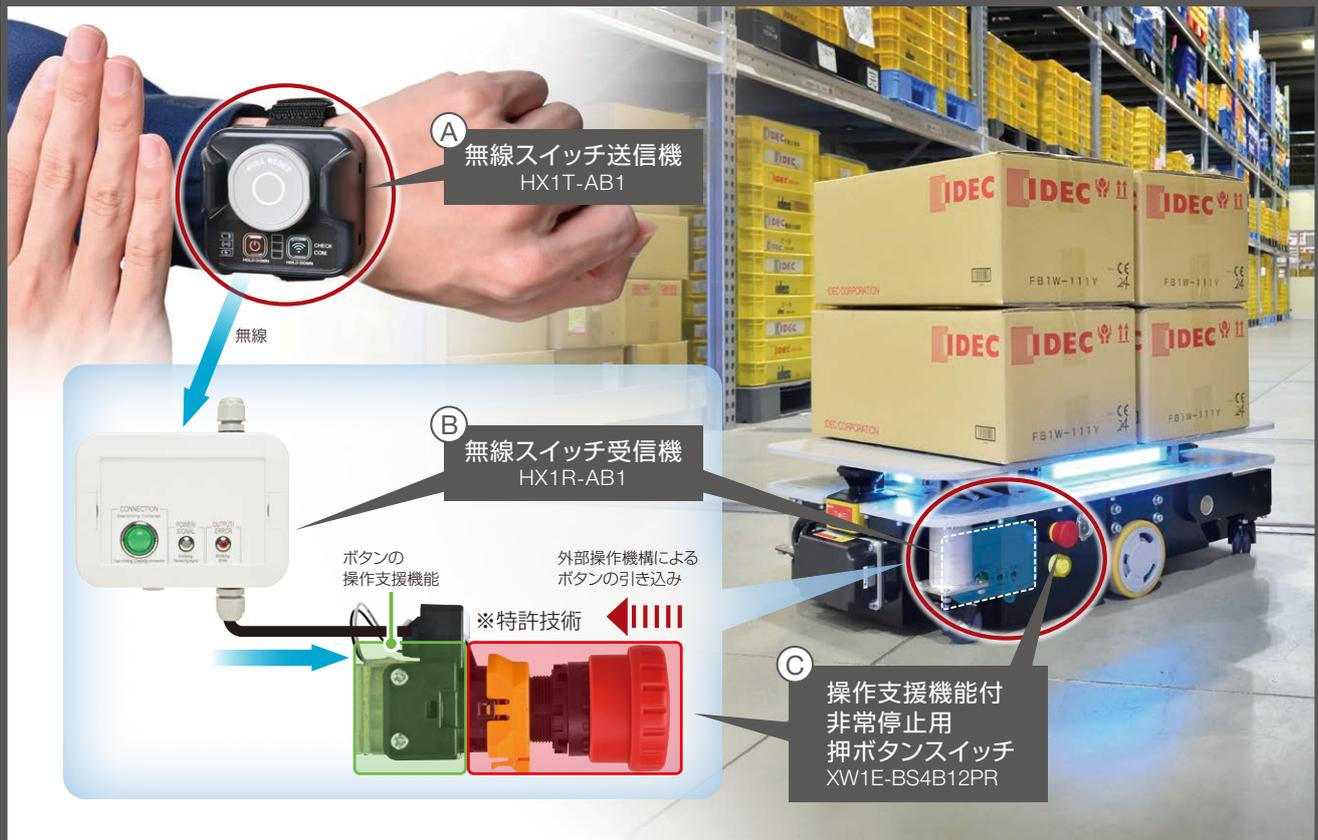
非常停止アシストシステムは、**A****B****C** の機器から構成されます。
