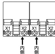
パイロットライト(トランス式)を上下・左右30mmピッチで集合取付けする場合は周囲温度40℃以下でご使用ください。
