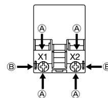
圧着端子の圧着部は絶縁被覆チューブ、キャップなどで絶縁して使用してください。
