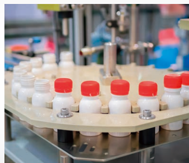
樹脂キャップ等搬送ライン
