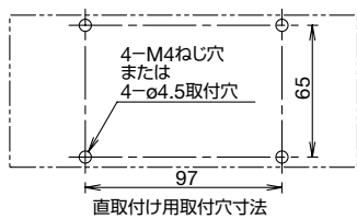
直取付け用取付穴寸法
