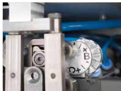
トリガーセンサを調整することで、適切なストリップ長を調整可能。
