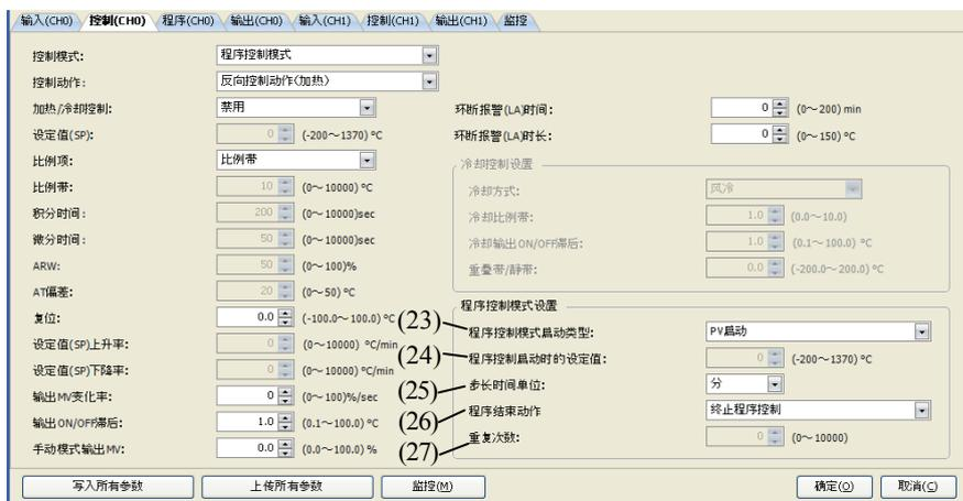
CH0控制的控制参数说明如下。当选择程序控制模式作为控制模式时，禁用固定设定值控制模式参数，如设定值 (SP)、比例带/比例增益或积分时间等。启用程序控制模式(23)至(27)的参数。
