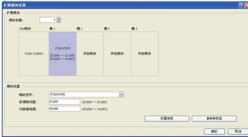
在确定模块数量并选择 PID 模块连接的槽号后，指定模块型号、控制寄存器（数据寄存器）和控制继电器（内部继电器）。在指定这些参数后，点击**设置参数按钮**，打开 PID 模块设置对话框。
