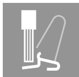
SNAP IN 接続を採用した Klippon Connect SNAP IN 式 S シリーズ端子台は、配線時に工具もフェールも不要。被覆を剥いた細より線を「カチッ」と音がするまで接続口に押し込むだけで配線が可能です。省工数を追求した革新的な接続方法です。
