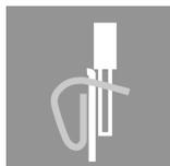
柔軟な配線作業に対応し、高い耐振動性を備えた Klippon Connect テンションクランプ式 Z シリーズ端子台はコンパクトで実用性に優れた盤設計に貢献します。ドライバを差し込みながら接続します。
