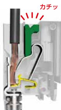
「カチッ」という音がしてロックが解除され、電線が接続されます。
