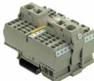
ZEI 6電流供給端子台は、最大10 mm<sup>2</sup>、ZEI 16電流供給端子台は、最大25 mm<sup>2</sup>の断面積の電線に対する、電流供給に使用できます。標準短絡接続により、断面積が小さい任意の数の端子台に電流を分配します。
