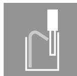
Push-in 接続を採用した Klippon Connect Push-in 式 A シリーズ端子台は、単線もしくはフェール付電線を配線部に押し込むだけでツールも使わずに配線が可能です。作業時間を最小限に抑え、高い安全性を保つ革新的な接続方法です。
