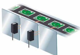
狭い設置場所からの検出
