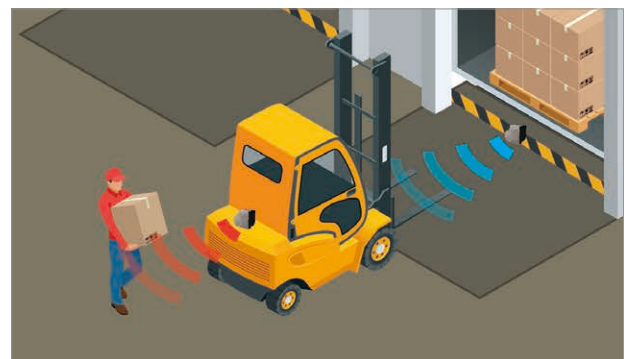
各業種 フォークリフト(ドライバーの死角、荷役作業時の衝突事故軽減) 形や色が複雑な人や移動体を検知
