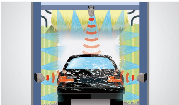
洗車機 洗車機での車幅の測長、車両の有無を検知 過酷な環境（水・湯気・太陽光）での車両検知
