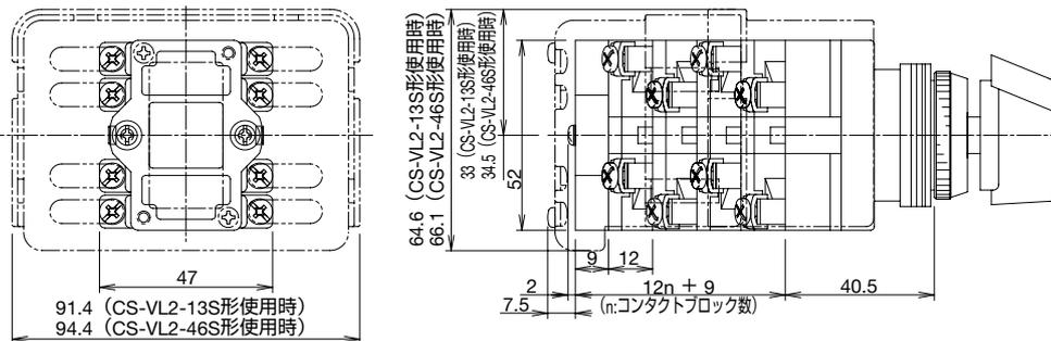
□ CS形カムスイッチ用端子カバーの取り付け方法
