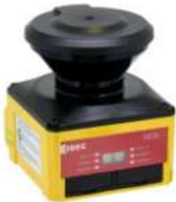
4月26日に発売するセーフティレーザスキャナ「SE2L 形」は、2段階の防護領域を設定することができ、機械を停止させる前に、減速を開始する領域を設定することができ、生産性の向上に貢献します。また検出距離5m、検出角度270°などハイスpek的な性能を有しており、IDECのセーフティコントローラや強制ガイド式リレー、安全スイッチ、非常停止用押ボタンスイッチなどを用いたシステム構成で生産現場の安全対策ソリューションを提案してまいります。
