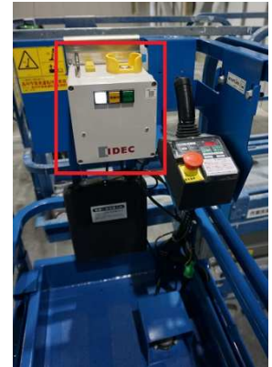
高所作業車に搭載された IDEC 製の挟まれ防止用システム
