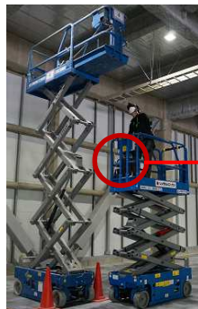
挟まれ防止システムを 搭載した高所作業車
