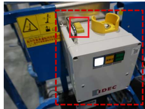
赤枠で囲っている部分が 3 ポジションイネーブルスイッチ （点線で囲っている部分がシステム）
