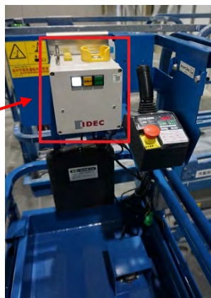
高所作業車（左）に搭載されたIDECの挟まれ防止用システム（右）
