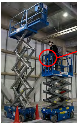
高所作業車（左）に搭載されたIDECの挟まれ防止用システム（右）
