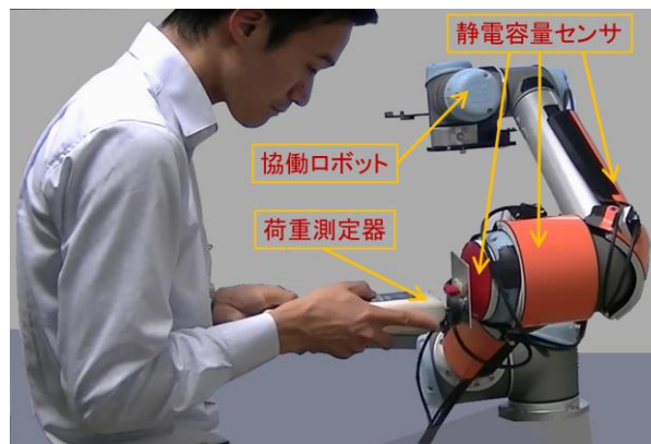
図 8 接触トルク測定の様子 Fig.8 State of torque measurement
