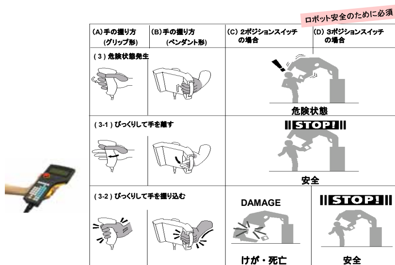
図 3 国際標準化に成功したロボット安全装置(3ポジションイネーブルスイッチ)の必要な背景
