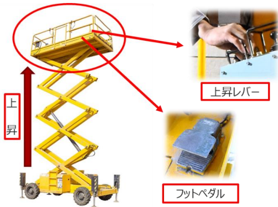
図2 高所作業車に搭載されている安全機能 Fig. 2 Safety features on elevating vehicles
